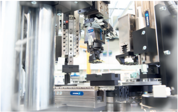
Handling von elektronischen Bauteilen
