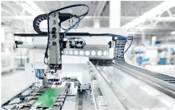
Nutzentrennung von Leiterplatten
