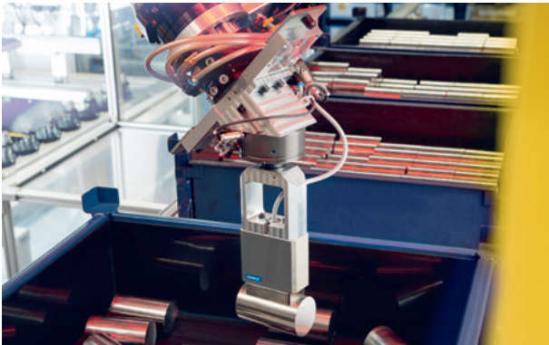
EGM: Bin-Picking von Rohteilen
