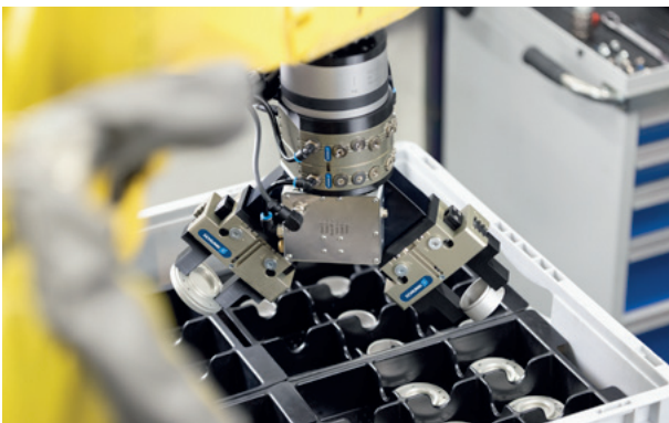
Doppelgreifer für flexible Werkstückhandhabung
