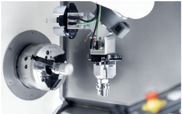
EGU/EZU: Flexible Werkzeugmaschinenbeladung
