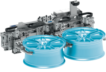
Doppelgreifeinheit zum Umsetzen von Felgen
